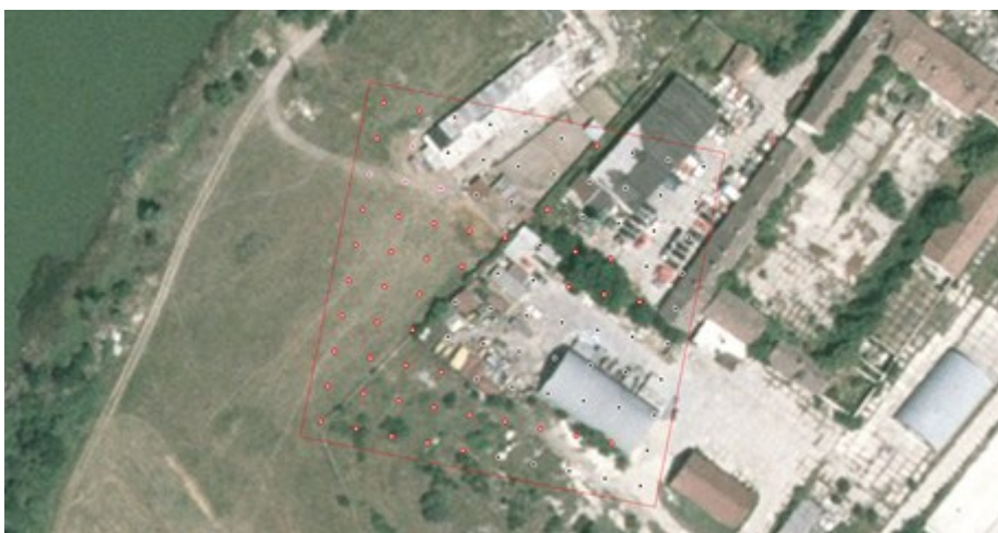
Obr. 1. Ukážka jedného pixela 100 \times 100 m vo vzorke a rozmiestnenia interpretovaných bodov v ňom s rozstupmi 10 m v prostredí ArcMap 10.2.2. Príslušné hodnoty tejto vzorky (v %) v IMD_2006_v1 až v5 sú 77, 77, 68, 27, v IR_2006_A 53 a v IR_2006_B 57.
